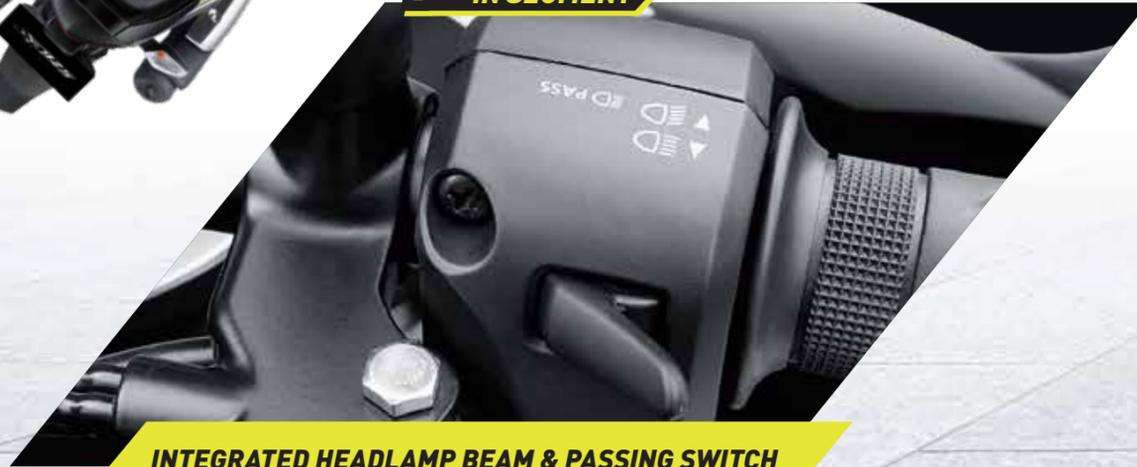
**INTEGRATED HEADLAMP BEAM & PASSING SWITCH**
